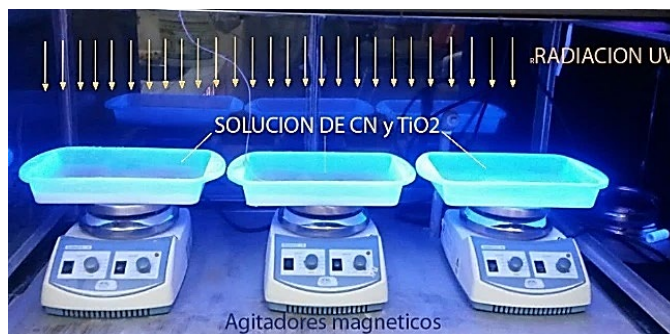
Figura 4. Configuración del sistema de oxidación fotocatalítica a nivel laboratorio
